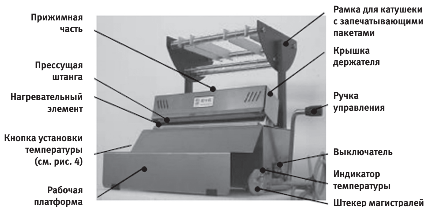
Рисунок 1. Схема структуры аппарата для запечатывания инструментов
